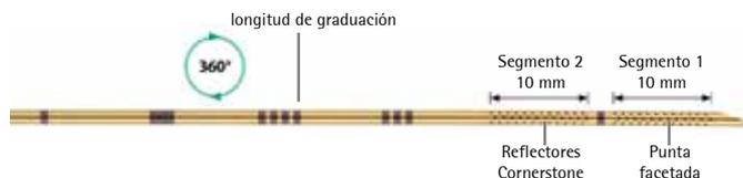
Una prueba con varios ángulos de inserción, aumentando en incrementos de 20 ° a 60 °, confirma que las cánulas de Sono son altamente visibles independientemente del ángulo de inserción.
